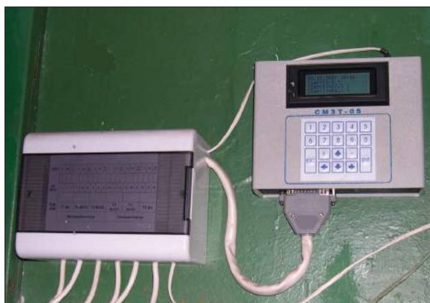
Рис. 5. Система мониторинга загрязнения теплообменников в работе.
